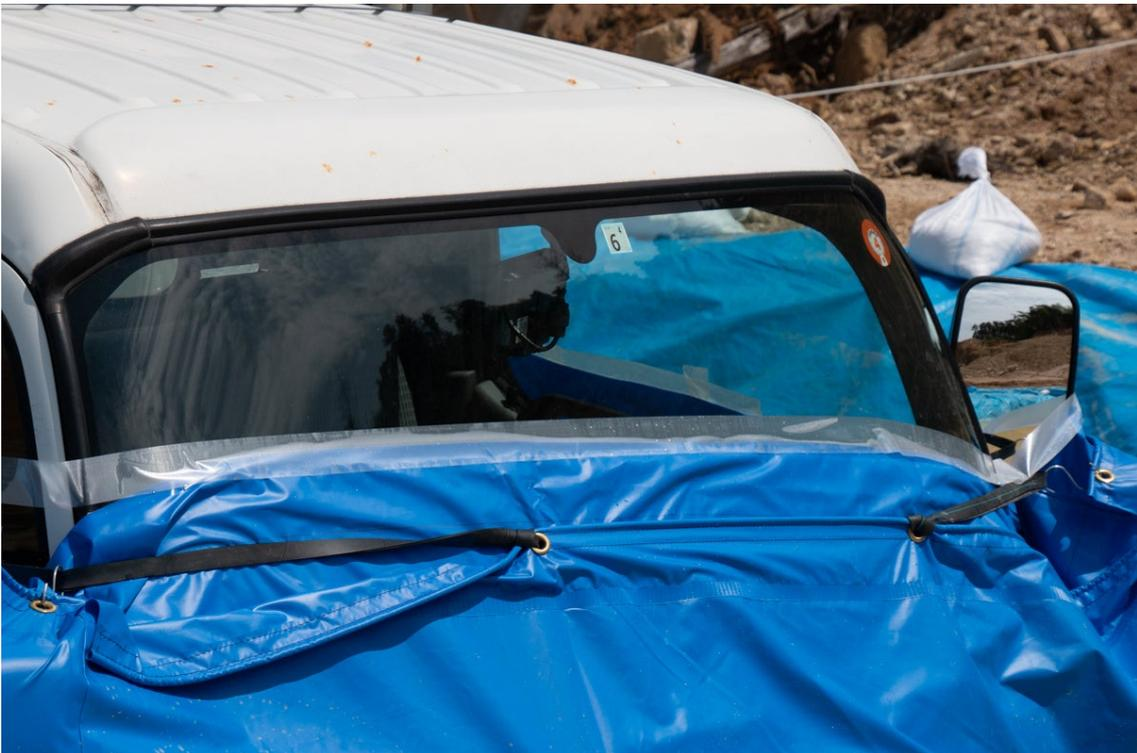
48時間後も「ウォーターセーフ」の内側には浸水は確認されず、エンジンの始動はもちろん実験前と変わらない状態で走行しました。
